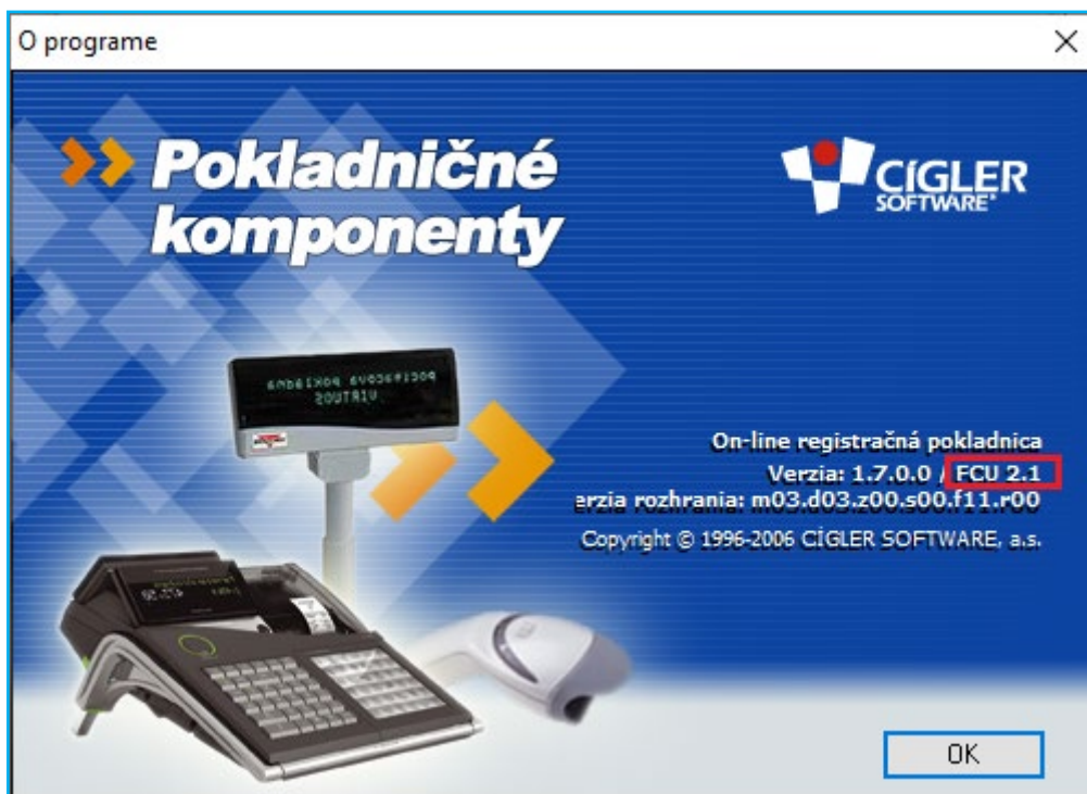
Ilustračný obr.: označené je umiestnenie čísla verzie rozhrania AFO-FCU (v tomto príp. 2.1). Vedľa je číslo verzie AFO.DLL (1.7.0.0)
